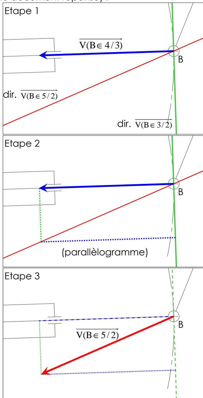
9. Du tracé précédent, on déduit  $\vec{V}(B \in 3/2)$ , puis grâce au champs de distribution des vecteurs vitesses, on peut tracer  $\vec{V}(F \in 3/2)$  (échelle du document réponse) :
