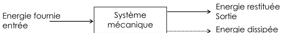
On appelle le rendement  $\eta$  le facteur qui caractérise l'énergie dissipée. Il s'écrit comme étant le rapport entre la puissance de sortie  $P_s$  et la puissance d'entrée  $P_e$  d'un système mécanique :
